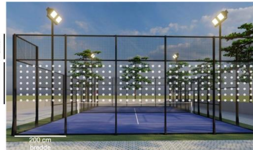
Figur 2: Udformning af foliebaner og klistermærker på endevæggen af en padelbane.
